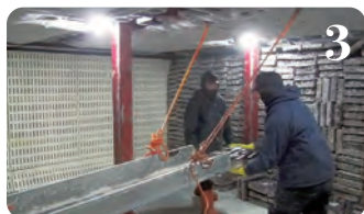
箱詰めしたイカは大型の冷凍室へ。マイナス60℃で急速冷凍して鮮度を保つ。
